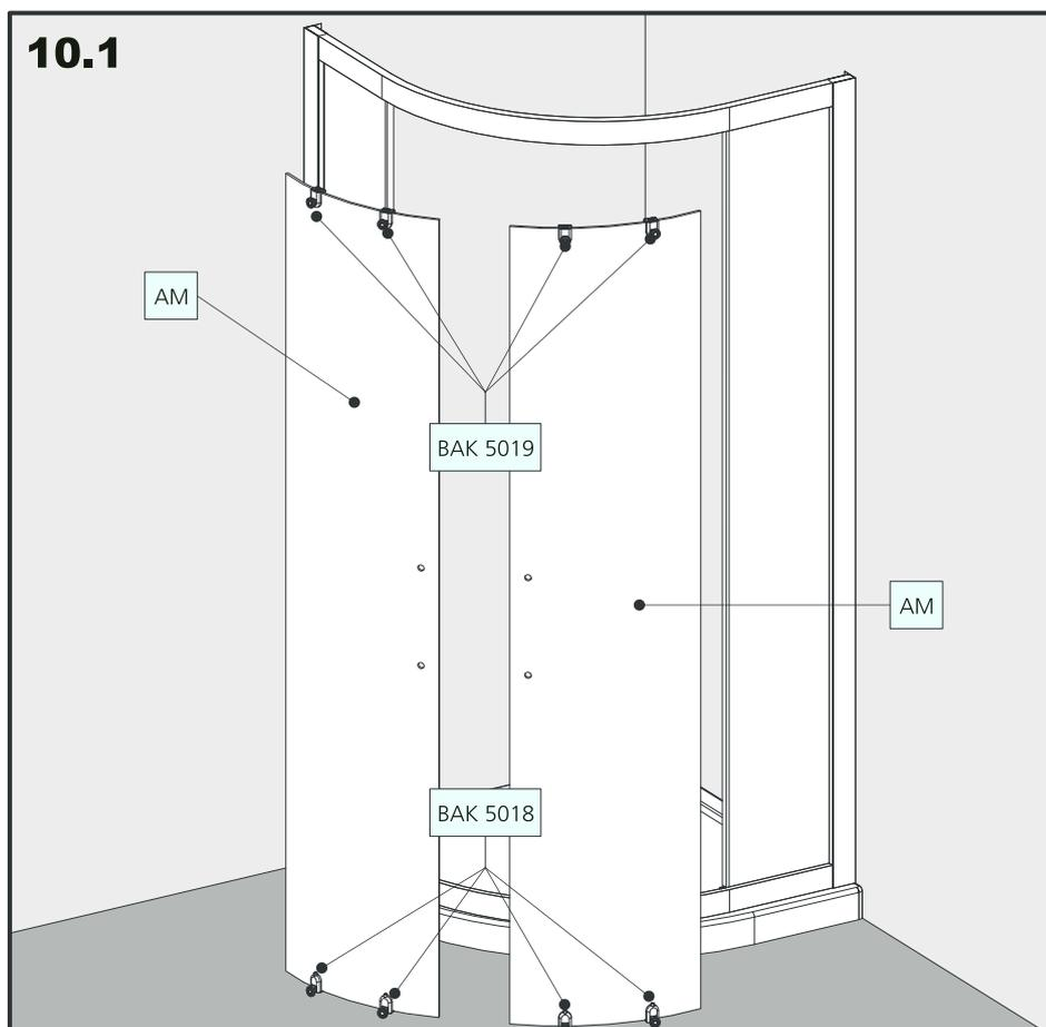
**11** Namontujte připravené horní a dolní pojezdy.
